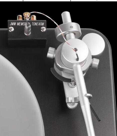
Der Arm sitzt in einer Standard-Rega-Bohrung 222 Millimeter von der Tellermitte entfernt. Das Tonarminnenkabel wird verdreht nach außen geführt und kann durch gezieltes Verdrehen einen Antiskatingeffekt erzeugen
