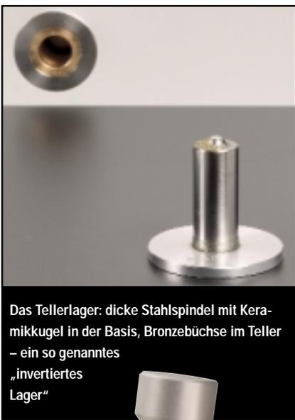
Das Tellerlager: dicke Stahlspindel mit Keramikugel in der Basis, Bronzebüchse im Teller – ein so genanntes „invertiertes Lager“
