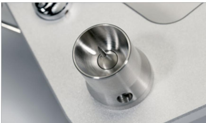
Der spitze Lagerdorn steht im Zentrum einer Wanne, die zur Bedämpfung mit Silikonöl befüllt werden kann
