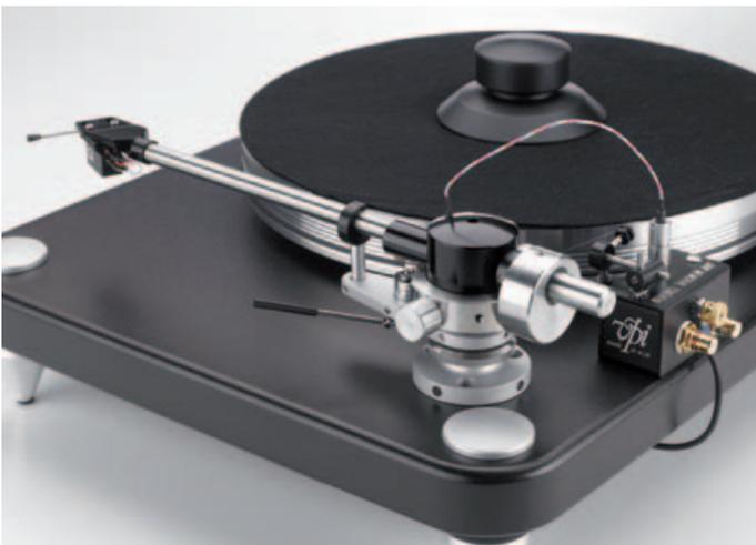
Bezüglich des Lieferumfangs ist VPI absolut vorbildlich. Werkzeug, Dosenlibelle und eine aufwendige Tonarm-Justageschablone liegen bei. Praktisch: die griffige Erdungsklemme an der Anschlussbox.
