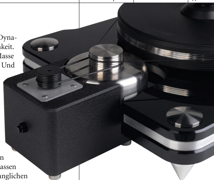
Flywheel: Der von der externen SDS-Steuerung versorgte Motor treibt ein gut 5 Kilo schweres Schwungrad an, das die Kraft dann via Riemen auf den Teller überträgt
