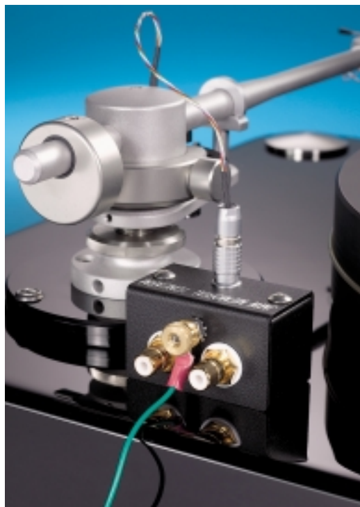
Die Anschlussbox mit den fest verschraubten Cinch-Buchsen kontaktiert über einen kleinen Stecker mit dem Tonarmkabel
