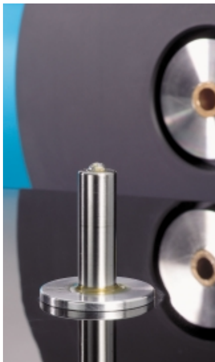
Die Bronzehülse des Invers-Lagers im Teller stülpt sich über eine fest stehende Stahlachse mit Stahlkugel, die auf einem Kevlarspiegel rotiert
