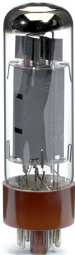
Die serienmäßig mitgelieferten EL34 sind ziemlich hoch bauende Typen
