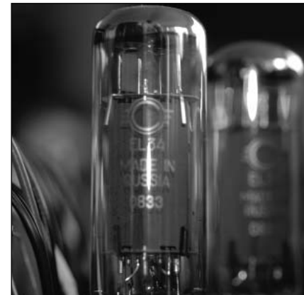
Pro Kanal arbeitet 1 Paar EL 34 aus russischer Fertigung als Leistungslieferant. Als Treiberröhren sind drei 5965 im Einsatz.
