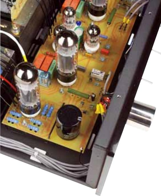
*Zwei EL34 in Push-Pull-Schaltung mobilisieren gut 30 Watt pro Seite – tatsächlich kommt der Aria mit einer Menge Boxen sehr gut zurecht*
