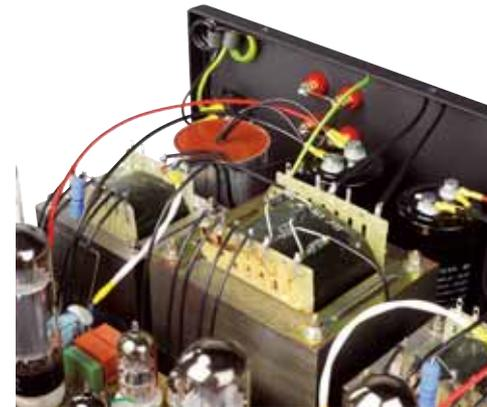
*Innen sieht fast alles aus wie früher: Offene Trafos und teilweise freie Verkabelung. Die Siebkondensatoren sind gegen Resonanzen vergossen*
