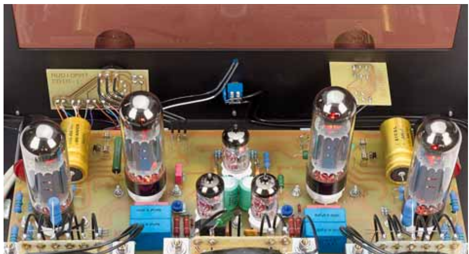
Drei ECC 83S in der Eingangsstufe sowie vier EL 34 für die Leistungserzeugung, allesamt selektierte Typen
